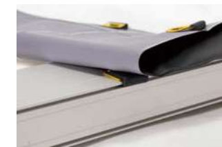
スナップレスフレームチューブ 取り付けたクリップがフレームの溝をスライド。革新的な方式。
