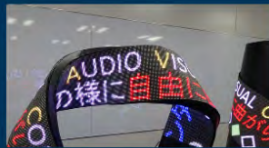
ラバー素材、及びフレキシブル基板を採用
